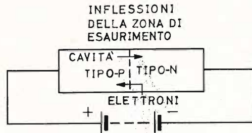
Fig. 3 - In questa figura si nota come, franando la zona di esaurimento, viene invertito il potenziale applicato, e il diodo entra in conduzione.
